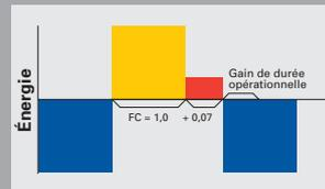
Avec facteur de charge (FC) de 1,07 : Effet simple de baisse de la température du fait du facteur de charge de 1,07 associé à un gain de durée opérationnelle
