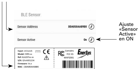
Pegatina de identificación en un sensor de BLE
